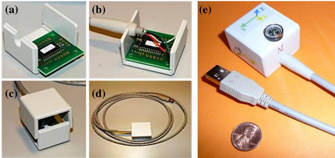
Fig. 1 (a) to (d) Assemblage of JoyWarrior24F8; (e) fully-assembled accelerometer
